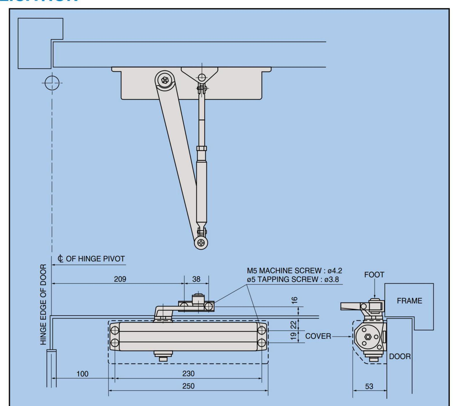
■CLOSER MOUNTED ON PULL SIDE OF DOOR
