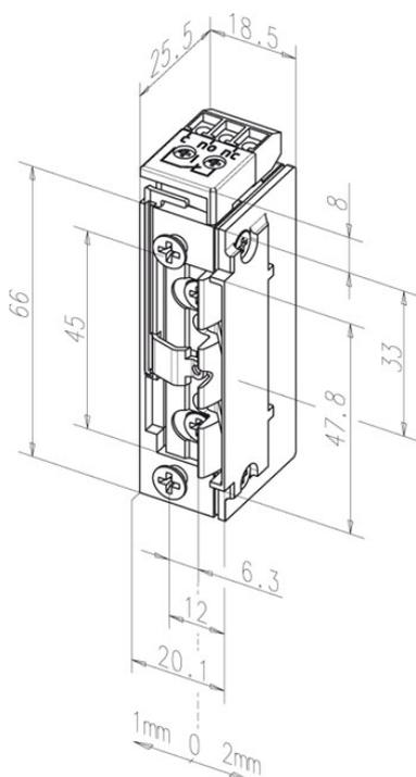
Modell mit Rückmeldekontakt als potentialfreier Wechselkontakt. Dieser wird von der Schlossfalle betätigt.
