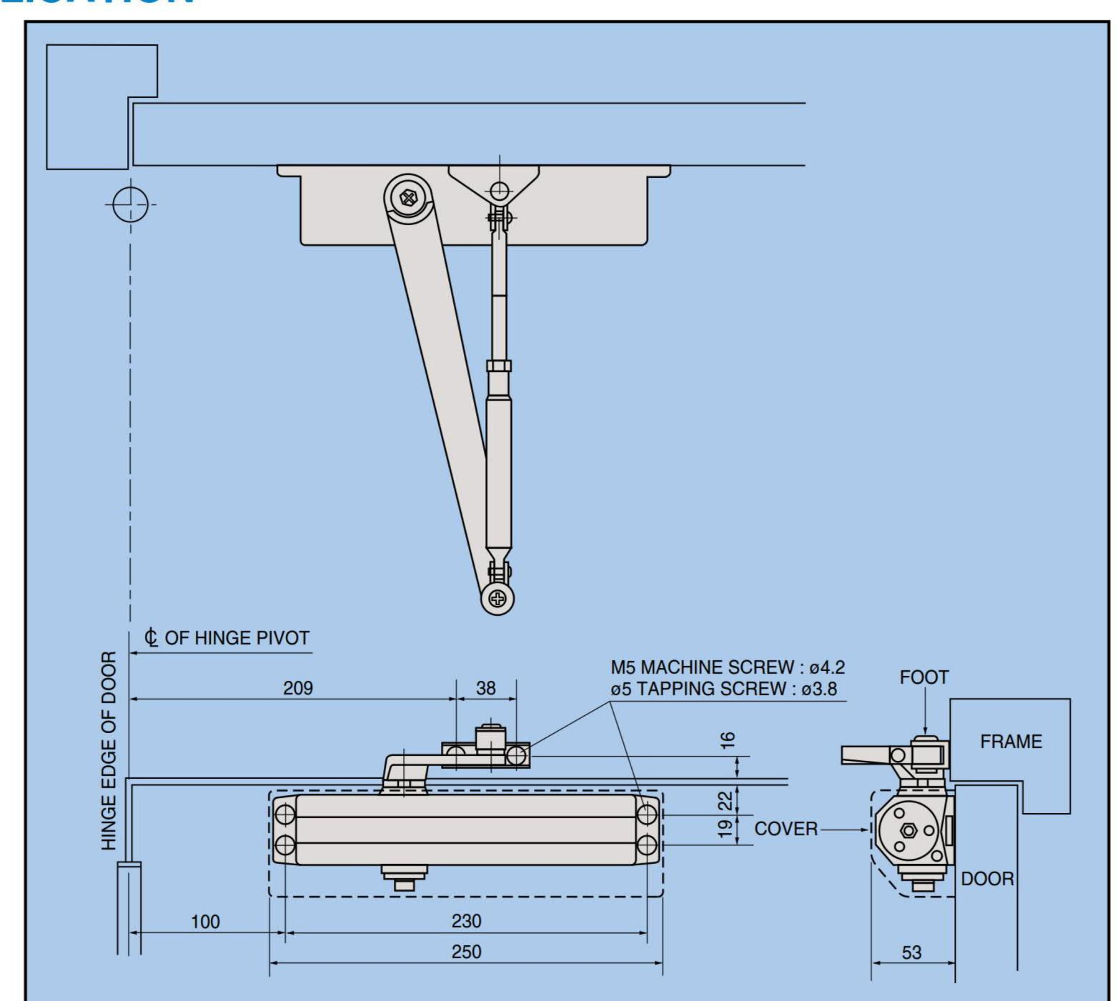
■ CLOSER MOUNTED ON PULL SIDE OF DOOR
